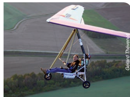
Caractéristiques techniques générales de l'ULM : LA MOUETTE, aile rigide carbone type TSUNAMI, 35 kg, surface 13 m 2 , envergure 12,8 m - Poids total au décollage 145 kg dont 70 kg de pilote - Vitesse : 18 à 56 km/h en version vol libre
